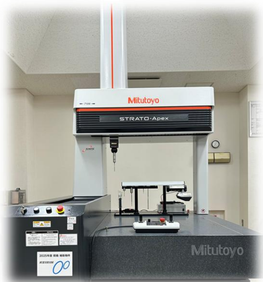
実機：ミットヨ製 / STRATO-Apex7106
